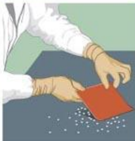
Соберите ртуть (скребком, щёткой, пылесосом, спринцовкой). Засыпьте труднодоступные места, где могли сохраниться капли ртути, мелким порошком серы или алюминиевой пудрой
